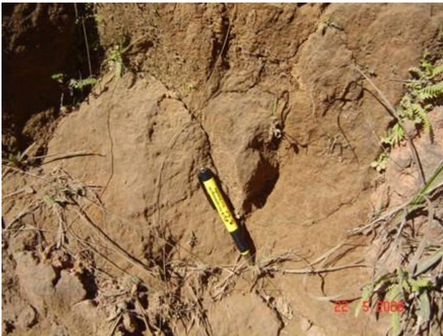
Figura 13 – Vista de estruturas reliquiare (fraturas e foliações) em afloramento de rocha alterada, granulação fina, siltes e argilas, amarelas e róseas. Área de influencia a sudoeste da área da Faz. Rio Grande.
