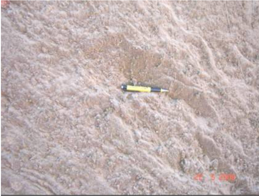
Figura 14 - Exposição de rocha alterada /solo de alteração cor vermelha, em corte da estrada de acesso a área. Siltitos de cor vermelha exibindo estruturas reliquiares de foliação e fraturamento de provável gnaiss.
