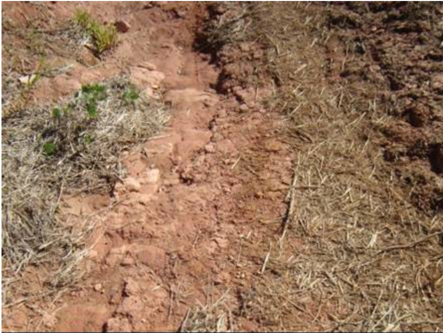
Figura 10a - Aspecto do solo da cobertura argilo siltoso,marrom, sobre argila siltosa com pouca areia fina, róseo a marrom avermelhado. Área da Faz. Rio Grande.
