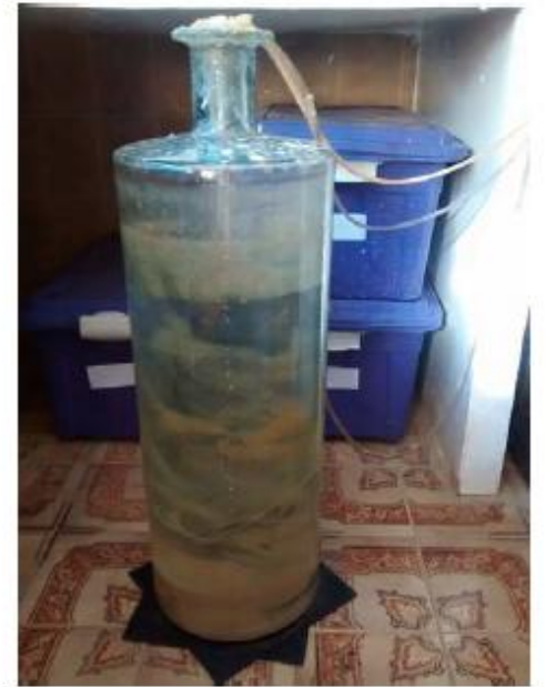
Foto 35 - Galão de armazenamento de água vedado com silicone e mangueras de sucção das bombas dosadoras
