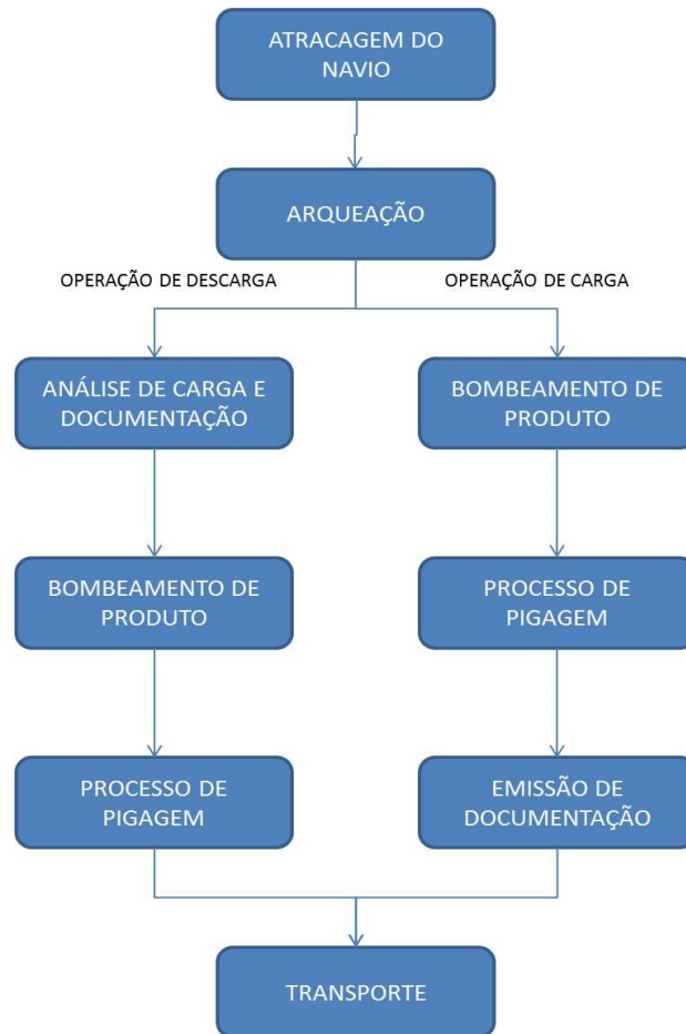
Figura 20: Fluxograma Operacional Marítimo das atividades para o carregamento e descarregamento de líquidos nos navios
